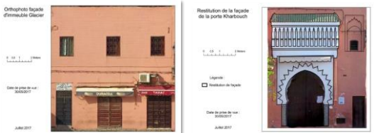
Orthophotos de façades: une mission à vol manuel, 2 lignes, 20 m des façades, recouvrements 3m x 3m.
