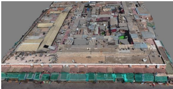
Place de Jemaa El-Fna : t= 4x20 min, H=30m, angle caméra 70°, 70%x70%, double grille.
