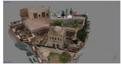
Nuage de points de la Kouba Almoravide avant filtrage (en haut) et une fois nettoyé (en bas)
