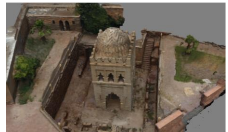
« Kouba Almoravide » et « Minaret de Kharbouch », vol circulaire, camera à 45°, recouvrement 12°.
